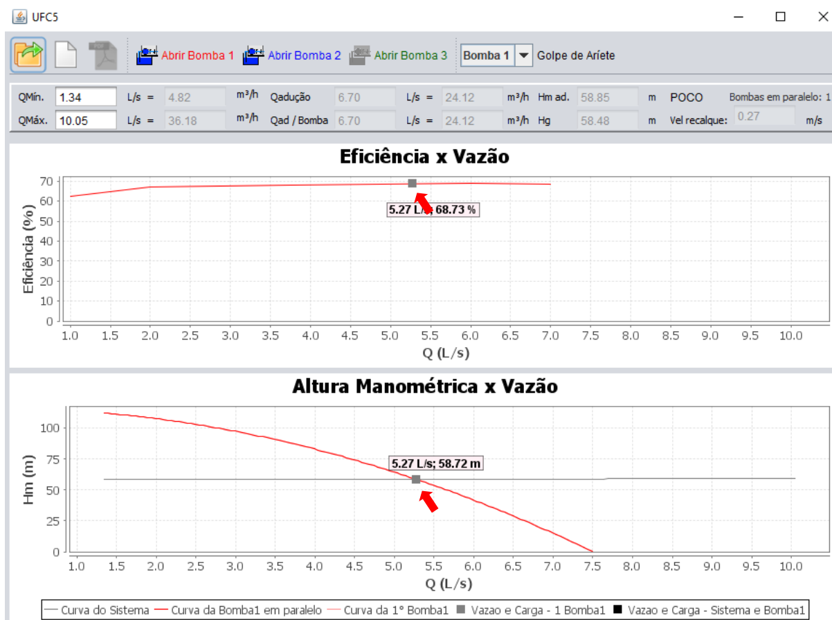
Figura 61-Ponto de trabalho do sistema para o Poço Profundo.
