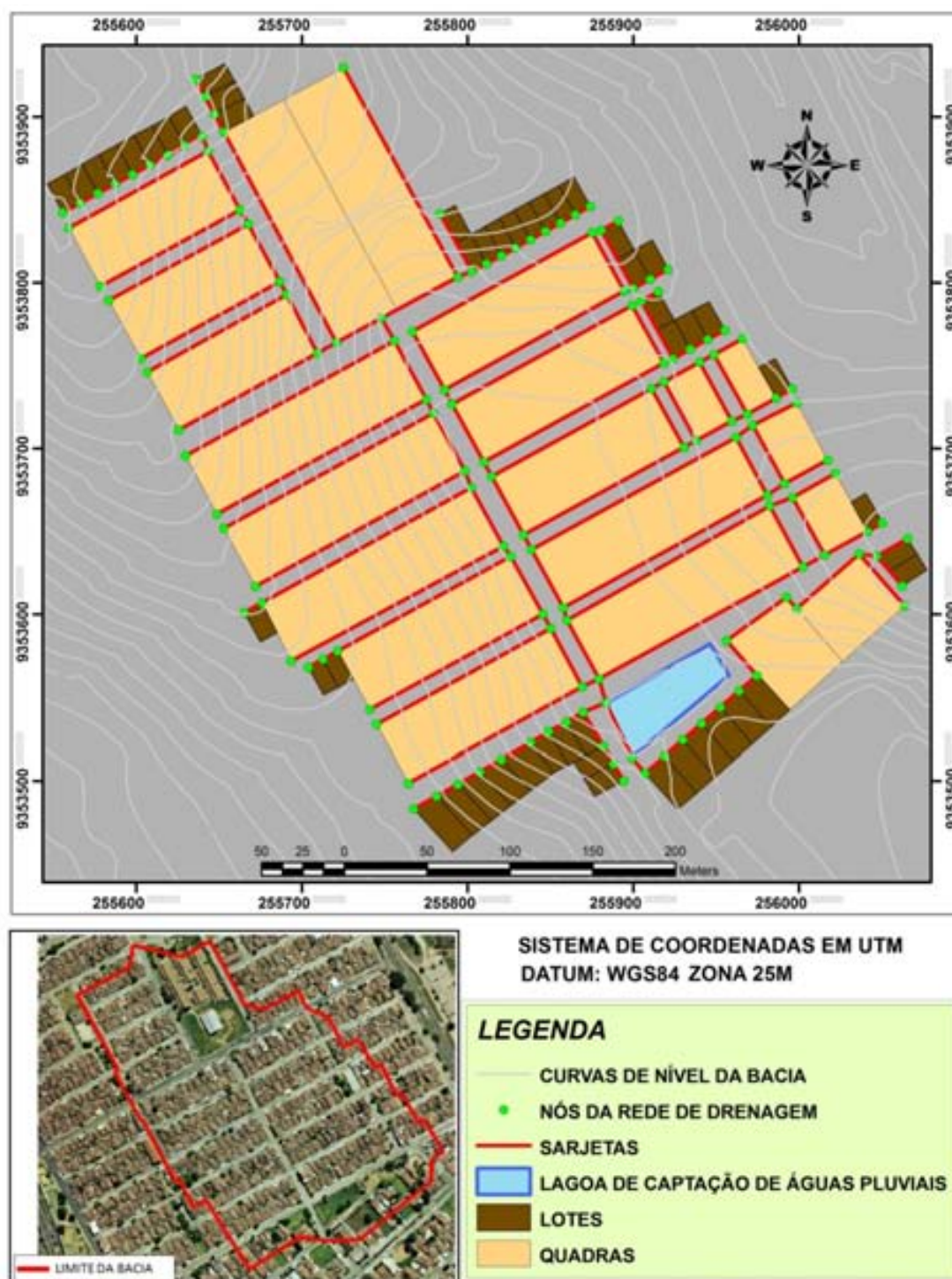
Figura 31 – Resultado da representação da bacia através de software de geoprocessamento
