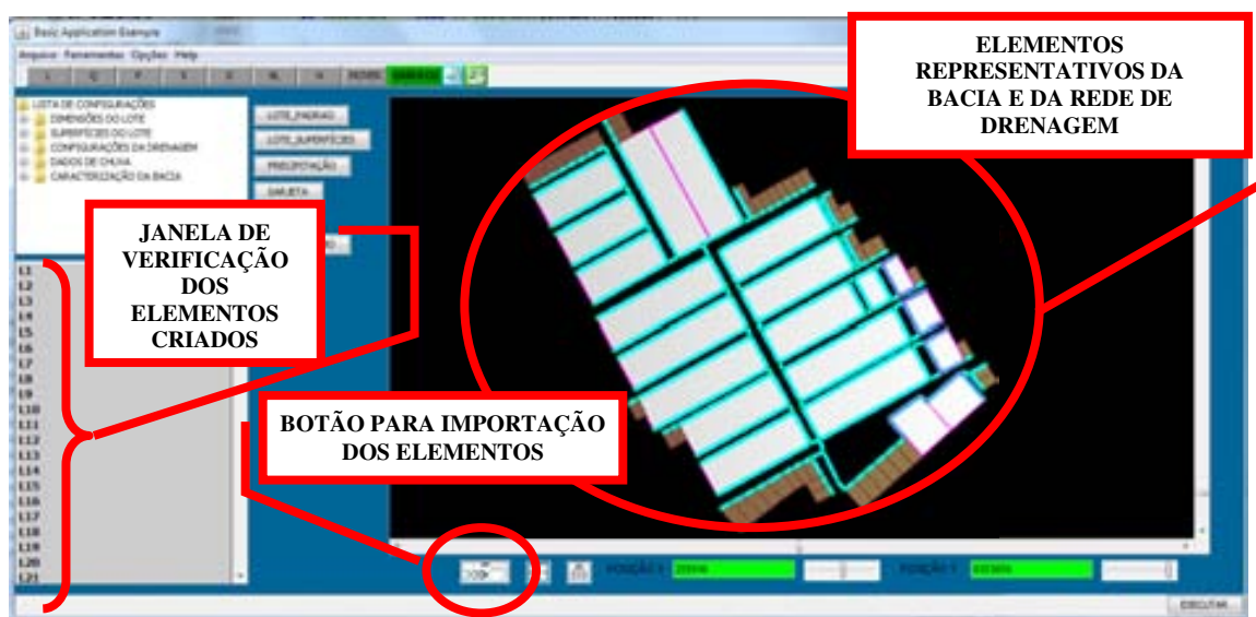
Figura 56 - Importação dos arquivos de texto para inserção dos elementos representativos da bacia através do modelo proposto
