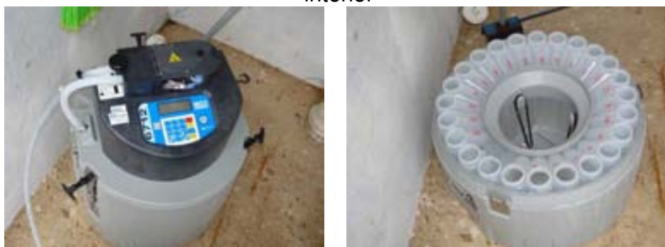
Figura 12 – Amostrador automático, com detalhe para a disposição das garrafas em seu interior
