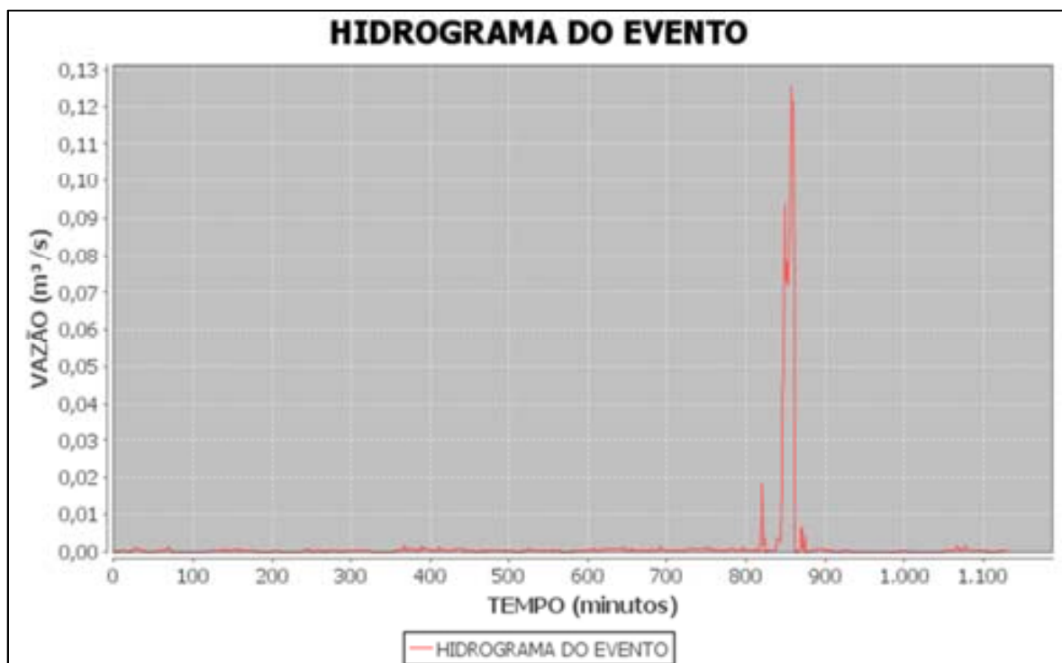
Figura 64 – Gráfico de vazão no exutório da bacia gerado pelo modelo proposto
