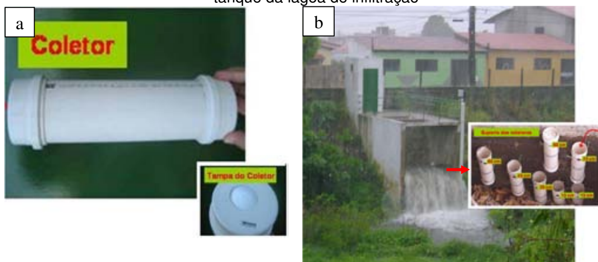
Figura 11 – a) Coletor e detalhe da tampa; b) Suporte para os coletores de água no tanque da lagoa de infiltração
