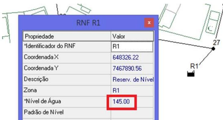
Figura 21: Imagem dos dados do reservatório no Epanet
